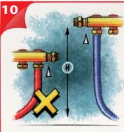
Prevedere uno spazio sufficiente sopra e sotto i collettori in maniera tale da rendere più agevoli le operazioni di connessione.
