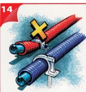
Con l'eccezione dei sistemi di riscaldamento/raffrescameto a pavimento, fissare il tubo al pavimento senza danneggiare la guaina o il tubo stesso.
