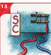
Quando il tubo serve a collegare due punti fissi, posare il tubo stesso prevedendo delle curve che consentano la dilatazione (curve a S o a C).
