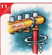
Gli sforzi effettuati durante le operazioni di installazione (trazioni, compressioni ...) non devono in alcun modo pregiudicare le caratteristiche del tubo.
