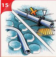
Nei sistemi di riscaldamento/raffrescamento a pavimento, fissare il tubo al pavimento utilizzando le apposite clips, non usare fili metallici.
