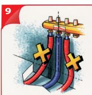
Per ottenere una connessione del tubo alle apparecchiature (per esempio collettori) è importante posare il tubo con la corretta angolazione.
