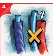
Fatta eccezione per gli impianti a pannello radiante, i tubi plasti devono essere posati già all'interno della guaina. Questa guaina protettiva garantisce lo spazio necessario per le dilatazioni del tubo.
